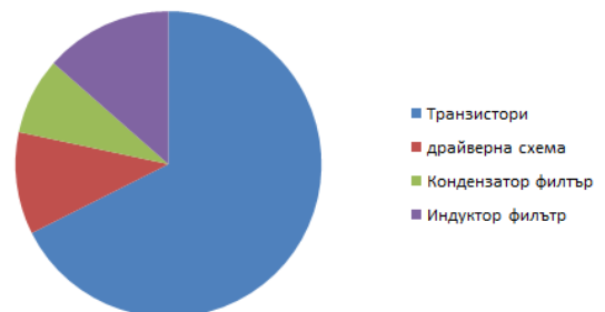
Фиг. 7. Процентно отношение на загубите в отделните спрямо общите загуби от разсейвана мощност на прав-повишаващ преобразувател
