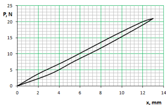
Фиг. 2. Еластична характеристика на силфон
