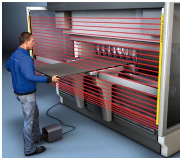
Фиг. 2. Инфрачервена завеса, осигуряваща безопасност на труда
