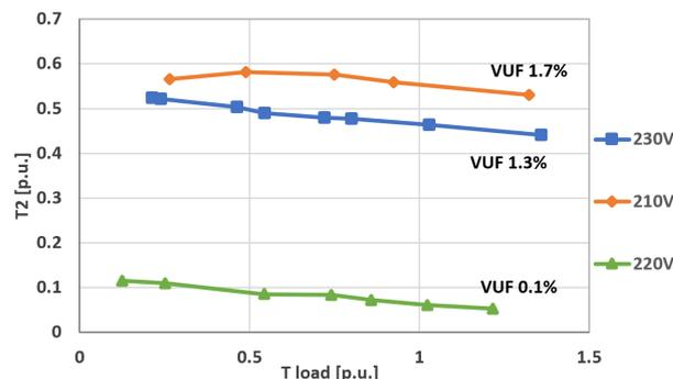
Fig. 8.  $T_2$  dependence on load
