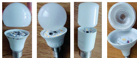
а) №8 - 7 W, 470 lm б) №10 - 5 W, 470 lm в) №11 - 9 W, 850 lm г) №13-15 W, 1000 lm
